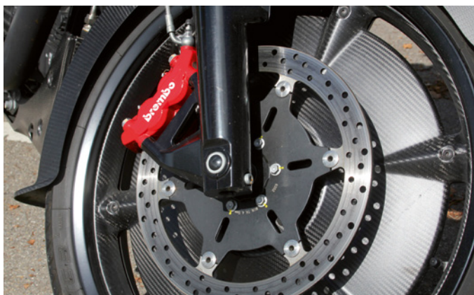
Radiel montierte Vierkolbenzangen – das bremst, wie man sich das wünscht
