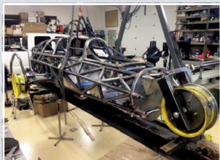
Sidecar Rohbau / Construction brute du side-car
