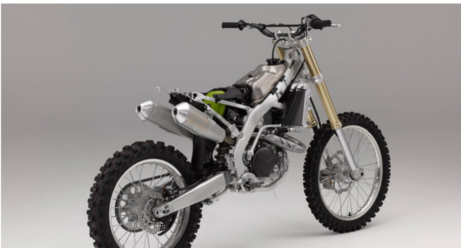
Crosser Naked: Massenzentralisation stand weit oben im Lastenheft der Ingenieure. Unter anderem sine die Auspuffe 78 mm kürzer /
